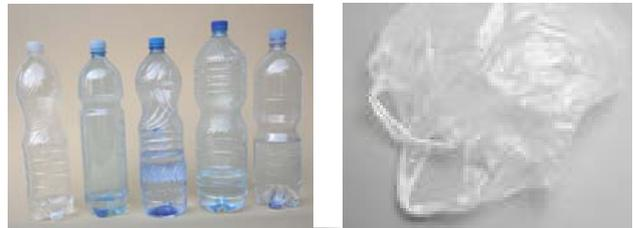
Biokunststoff wird mit Hilfe neuartiger Technologien z.B. aus Melasse, einem Nebenprodukt der Zuckerherstellung, produziert. Diese Verpackungs-Kunststoffe haben die gleichen Eigenschaften wie herkömmliche, erdölbasierte Kunststoffe, sind aber zum Teil oder zu 100 % aus nachwachsenden Rohstoffen hergestellt und besser recycelbar. Mit Hilfe der  $^{14}\text{C}$ -Bestimmung kann dieser Anteil an nachwachsenden Rohstoffen überprüft und quantifiziert werden.
